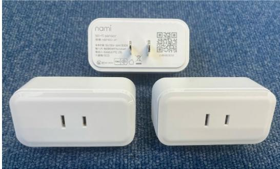
図 1：スマートプラグ型 WiFi センサー（活動検知）
